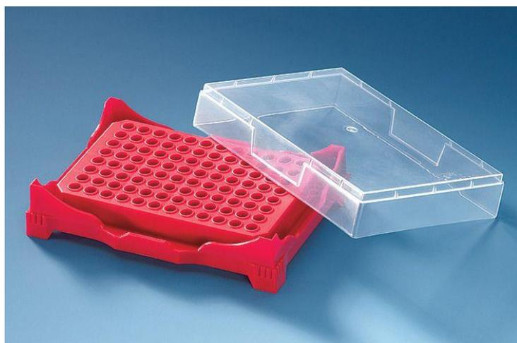
Dos elementos adecuados para la preparación de muestras, el almacenamiento y la conservación de tubos individuales de 0,2 ml, de tiras de 8 y 12 tubos de 0,2 ml, así como de placas PCR de 96 pocillos.
