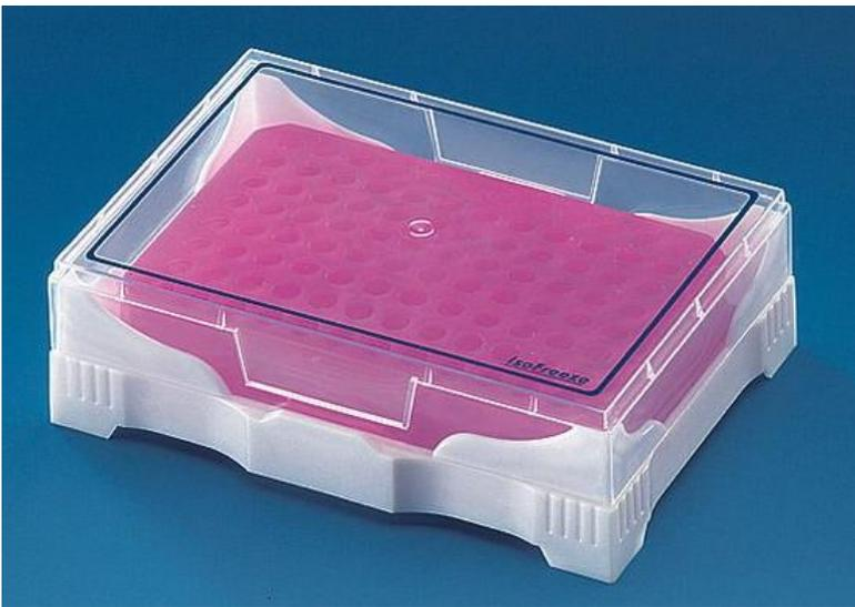
En PP. Para proteger muestras del calentamiento. El mini refrigerador de PCR mantiene las muestras a 4 °C durante aproximadamente 3 horas. El gel aislante cambia de violeta a rosa a 7 °C. Adecuado para tubos individuales de 0,2 ml, 8 tiras y 12 tiras, así como placas de PCR de 96 pocillos.
