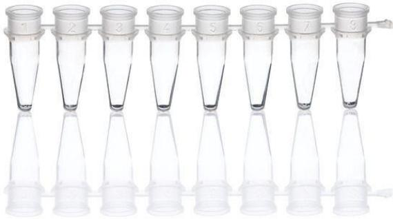
Tira de 8 tubos de 0.2 ml. Con tapas planas separadas de la tira de tubos. Se pueden abrir y cerrar fácilmente, sin herramientas. Los tubos disponen de una correa de sujeción en un extremo, y las tiras de tapas cuentan con un pequeño saliente lateral, que permite una apertura cuidadosa y libre de contaminación.
