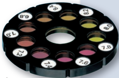
Disco de color con estándares de vidrio resistente al color
