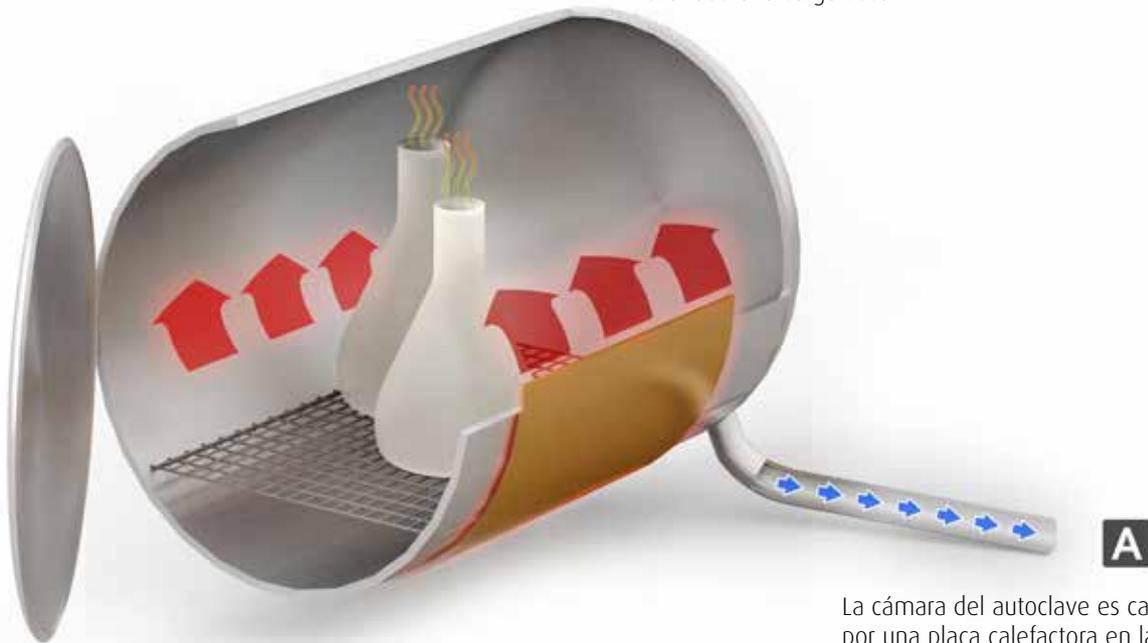
La cámara del autoclave es calentada por una placa calefactora en la pared externa de la cámara.
