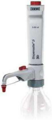
Dispensadores Ya sea que esté dispensando disolventes, ácidos, álcalis o soluciones salinas, el dispensador de botella Dispensette® S lo hace fácil, seguro y eficiente.
