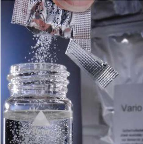
Solo hay que abrir el paquete de aluminio y verter el contenido en la muestra de agua:
