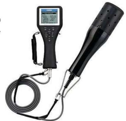
(pH, pH (mv), ORP, OD, COND, salinidad, TDS, gravedad específica del agua de mar, temperatura, turbidez, profundidad del agua).
