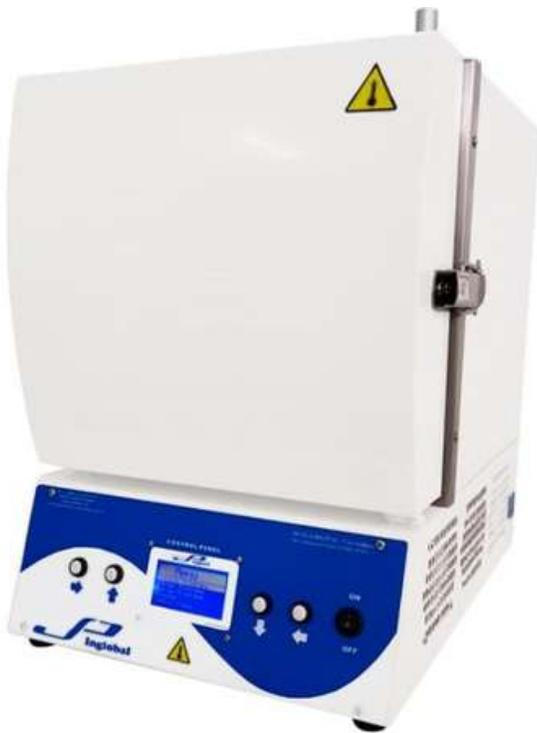
Mufla Las Muflas son utilizadas para realizar pruebas a temperaturas altas con o sin ambiente controlado. Las Muflas marca JP inglobal vienen desde 4.5 Litros hasta 254 Litros de capacidad con una temperatura variable desde 100°C hasta 1700°C. características básicas:
