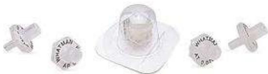
Filtros de membrana para filtración de fase móvil
