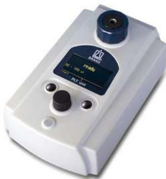
La causa más frecuente de inexactitud en las pipetas de pistón son las fugas. Esto se debe a daños en los sellos, pistones o conos de punta. A menudo, las fugas no son detectables a simple vista y provocan errores de volumen importantes. El comprobador de fugas de pipetas BRAND (unidad PLT) para pipetas de desplazamiento de air e detecta incluso las fugas más pequeñas en cuestión de segundos.
